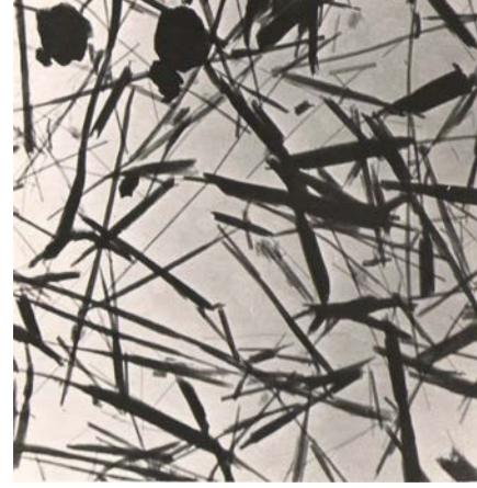
Şək. 4. Zəylik halluazitinin (nüm. 58) elektron mikroskopu altında görünüşü (11000 dəfə böyüdülmüşdür)
