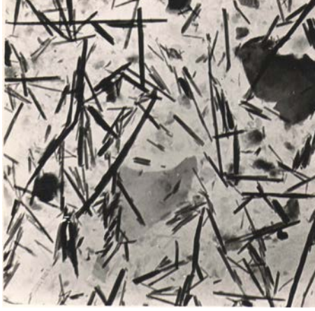
Şək. 3. Çardaxlı halluazitinin (nüm. 77) elektron mikroskopu altında görünüşü (11000 dəfə böyüdülmüşdür)
